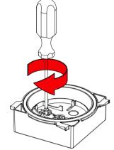
Bodenplatte der IL-Leuchte anschrauben.
