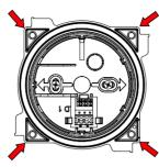
Zeichnen Sie die Befestigungslöcher an und bohren sie.
