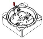
Entfernen Sie die Platine aus der IL-Leuchte.
