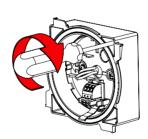
Schrauben Sie das Gehäuse an der Wand/Decke an. (Schrauben nicht im Lieferumfang enthalten)
